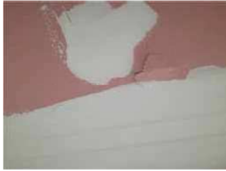
Particolari delle lesioni dopo l'urto n. 1
